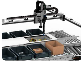
> Entnahme und Ablage in unterteilte Behältern
