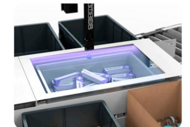
> Die Produkthöhen-erkennung sorgt für eine kontrollierte und präzise Platzierung der Artikel
